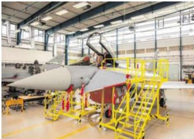
Für die Wartungsarbeiten und Reparaturen an Luftfahrzeugen wird eine Vielzahl an unterschiedlichen Leitern und Plattformen benötigt. Die Lehrmittelwerkstatt der Luftwaffe fertigt diese auch für den Fliegerhorst Kaufbeuren. Foto: Felix Blesch (Archivbild)
