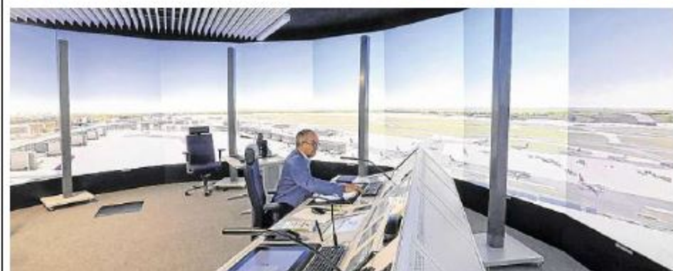
Der Tower-Simulator besteht aus 16 Laser-Beamern mit einer Auflösung von 36 Millionen Pixel. Auf unserem Foto zeigt Peter Willmann eine Darstellung des Frankfurter Flughafens.
